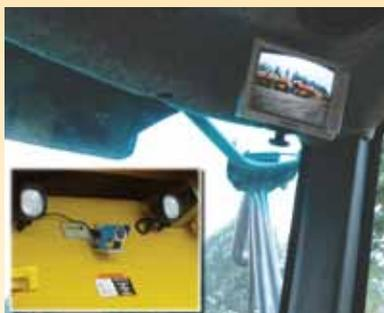
Das optionale Reifendruck-Überwachungssystem stellt dem Fahrer Informationen zum Reifenluftdruck in Echtzeit zur Verfügung.
