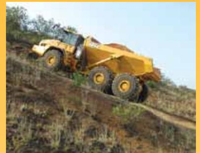
Der serienmäßig integrierte Roll- und Nickwinkelsensor überwacht den Kippvorgang. Bei Aktivierung kann ein Anheben der Mulde bei bedenklichem Stand verhindert werden.
