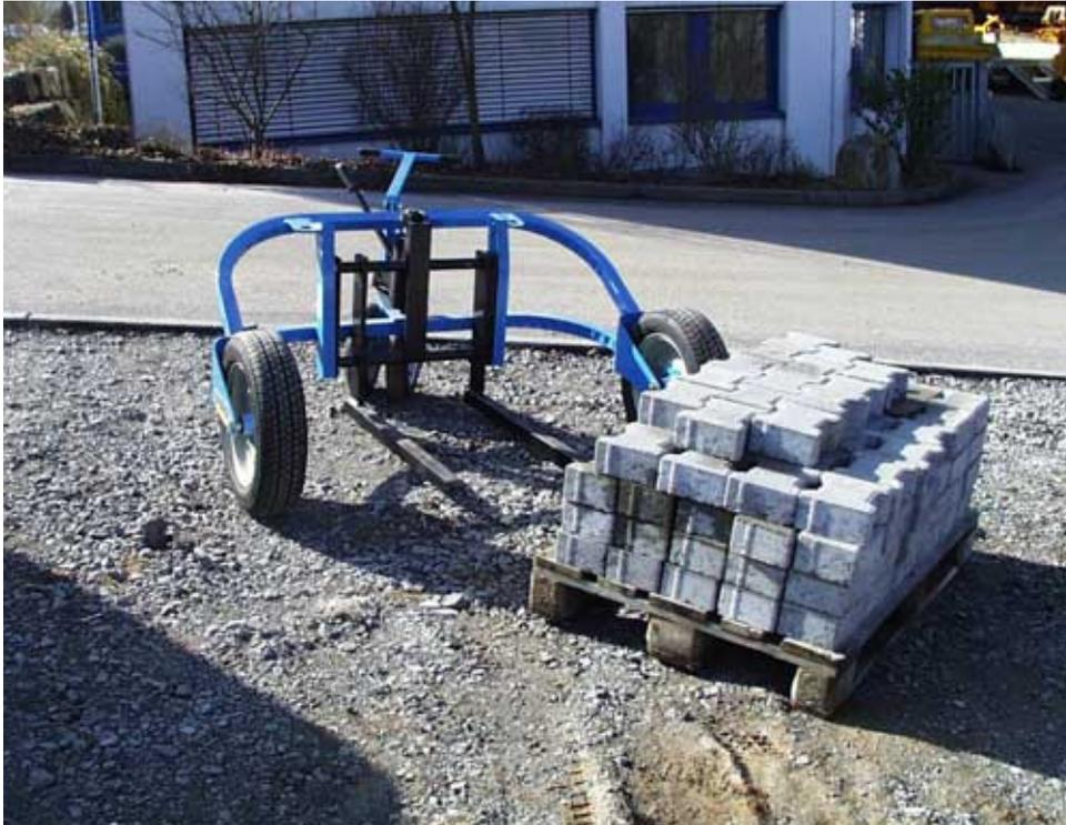
Der Palettenwagen PW III überzeugt durch einfache Handhabung und Details auf jeder Baustelle. Durch groß dimensionierte Gummiräder kann der Palettenwagen auf jedem Untergrund bewegt werden und ist so zum Transport von kompletten Baustoffpaketen geeignet. Mittels Hydraulikzylinder wird die Palette angehoben und gesenkt. Günstige Lastverhältnisse sorgen für ein gutes Handling.
