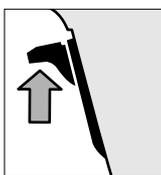
Pour **bloquer** l'interrupteur Marche/Arrêt appuyé **6**, poussez vers le haut le bouton de verrouillage **5**.
