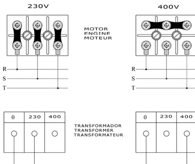
**IMPORTANTE:** Sempre que mude a posição das placas na caixa de bornes do motor, deverá proceder também à mudança das etiquetas adesivas indicativas da voltagem de alimentação, para que estejam de acordo com a mudança efectuada. **Muito importante desligar a máquina da corrente antes de realizar a mudança de voltagem.**
