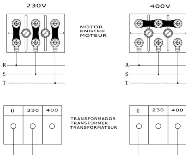
**IMPORTANT :** à chaque changement de position des plaquettes sur les bornes du moteur, vous devrez aussi changer les étiquettes adhésives indiquant le voltage de l'alimentation électrique, afin qu'elles soient en accord avec le changement effectué. **Très important, débrancher toujours la machine du courant électrique avant d'effectuer le changement de voltage.**
