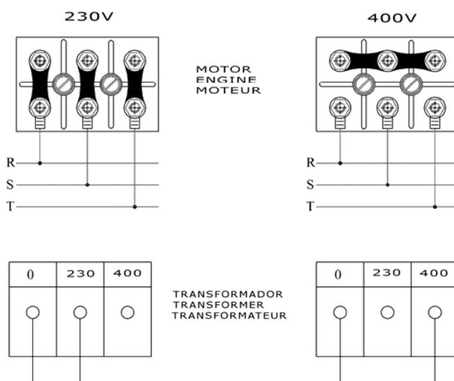
**IMPORTANTE:** Siempre que se proceda a cambiar la posición de las plaquitas puente en los motores, se deberá proceder también a cambiar las etiquetas adhesivas indicativas del voltaje de alimentación, para que estén en coincidencia con el cambio efectuado. **Muy importante desconectar la maquina de la red antes de realizar el cambio de voltaje.**
