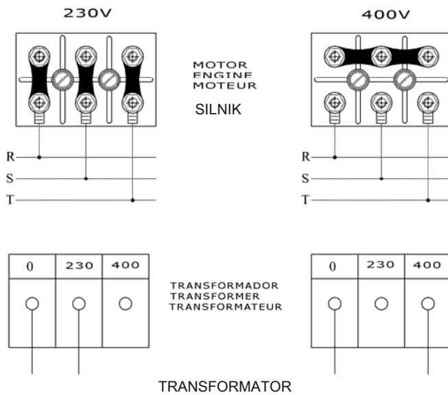
**WAŻNE:** Zawsze gdy zmienia się pozycję blaszek na mostku silnika trzeba również zastąpić samoprzylepne etykietki informujące o napięciu zasilania nowymi, aby w ten sposób był zawsze pokazany woltaż, przy którym pracuje maszyna. **Bardzo ważne: należy odłączyć maszynę od prądu przed przystąpieniem do zmiany napięcia.**
