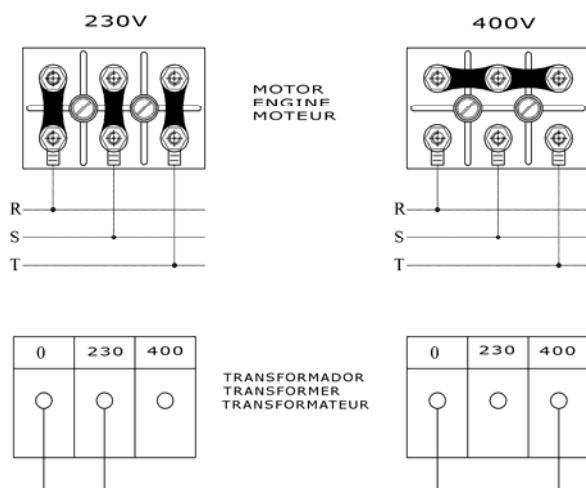
**WICHTIG:** Sollten Sie die Spannung ändern, so müssen Sie die spannungsanzeigenden Etiketten ändern. **Stöpseln Sie die Maschine zuvor aus.**
