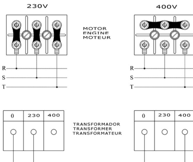
**IMPORTANTE:** Ogni volta che si procede al cambio della posizione delle placchette ponte nei contatti del motore, si dovrà cambiare successivamente le etichette adesive indicanti il voltaggio dell'alimentazione, in modo che coincidano con il cambio elettrico effettuato. **Molto importante scollegare dalla corrente elettrica la macchina prima di realizzare il cambio di voltaggio.**
