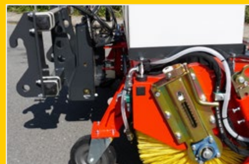
Schwere Radladeraufnahme mit 3D-Niveausausgleich über Rollenführung
