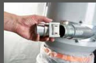
Mit Klicksystem zur Saugschlauchbefestigung
