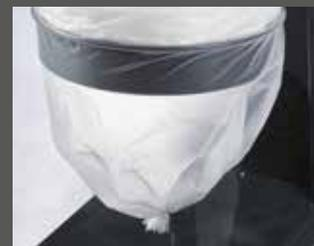
Einfache und sichere Staubentsorgung über Longbag
