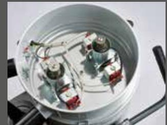
Automatische mechanische Filterreinigung
