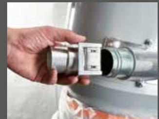
Mit Klicksystem zur Saugschlauchbefestigung
